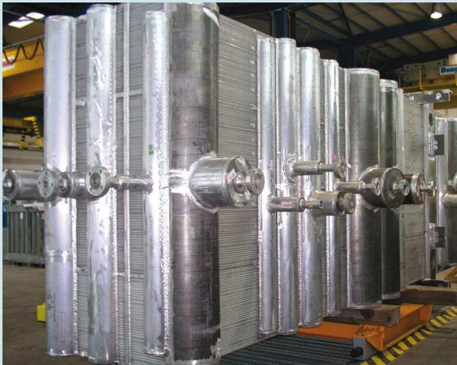
Пластинчатый теплообменник в производственном цеху
