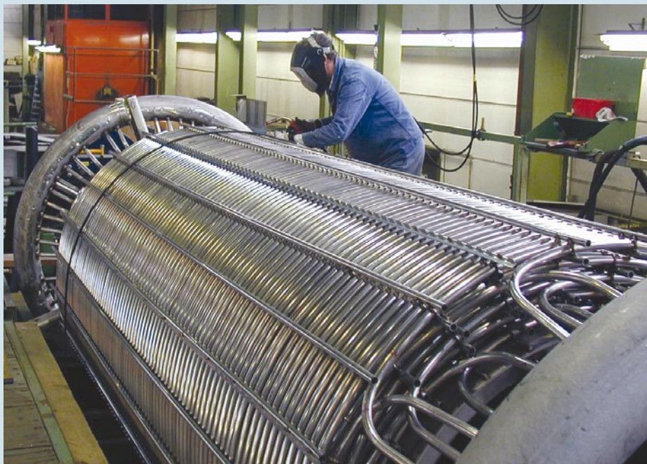
Изготовление водяного испарителя
